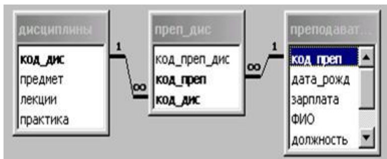
Рис. 5. Схема данных с использованием вспомогательной таблицы
